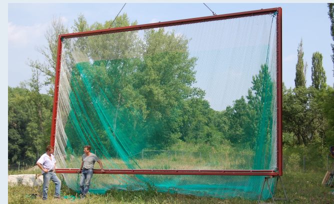
Turbinenhamen, Foto: J. Riecken-Dietrich
