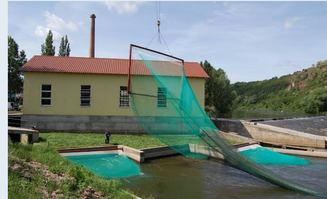
Installation Turbinenhamen, Foto: G. Ebel
