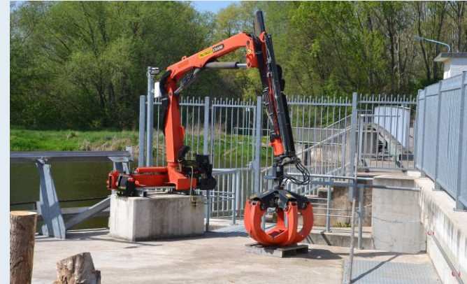
Hydraulik-Ladekran mit Sterngreifer, Foto: G. Ebel
