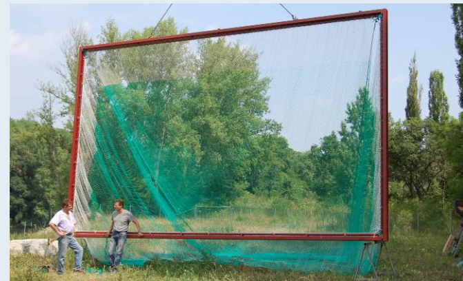
Turbinenhamen, Foto: J. Riecken-Dietrich
