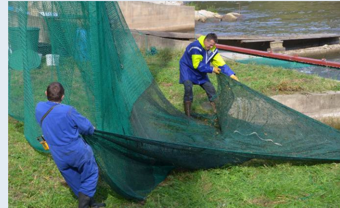
Hebung eines Turbinenhamens, Foto: D. Möbius
