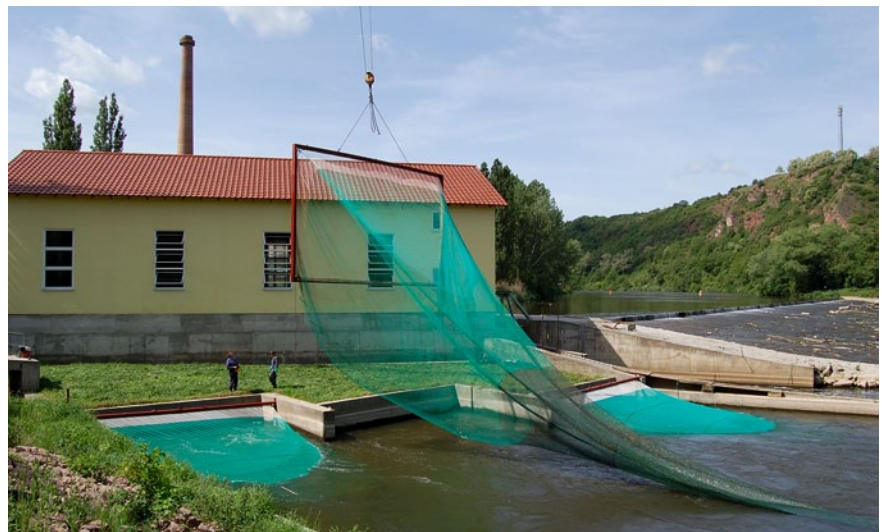
Bild 5: Eine wesentliche Bedeutung für die Fortentwicklung des gegenwärtigen Kenntnisstandes besitzen u. a. Studien zur biologischen Funktion von ausgeführten Fischschutz- und Fischabstiegssystemen mit Bypasshamen (oben) und Turbinenhamen (unten); zur Beschreibung der selektiven Wirkung der Fanggeräte sowie der Effizienz des Fischschutz- und Fischabstiegssystems finden vorzugsweise logistische Regressionsverfahren Anwendung [1]
