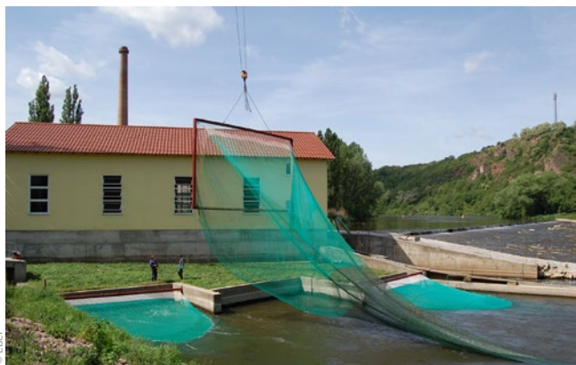
Bild 4: Netzartige Fanggeräte wurden beispielsweise am Standort Rothenburg für die Ermittlung der biologischen Effizienz eingesetzt: Hamen im Austrittsprofil der Saugrohre (links), Schwalgreuse im Austrittsprofil des Bypasses (rechts)
